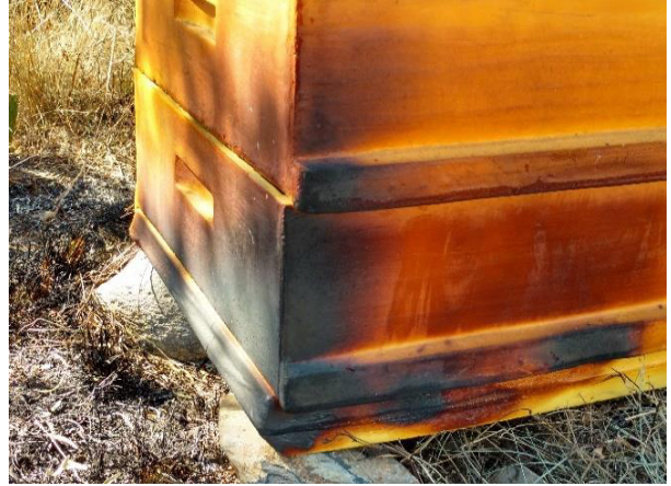
Figura 7. Esquina con mayor daño en colmena de poliuretano (Colmena Mariana).
